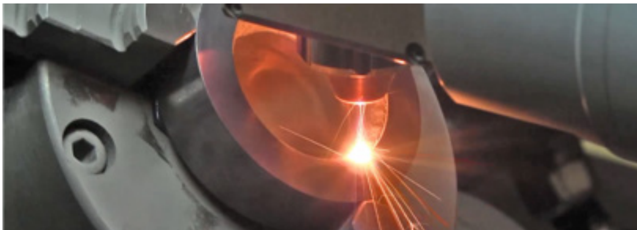
Detalle del proceso de recarga láser de un alojamiento interior de un disco de acero (IK4-Tekniker)
