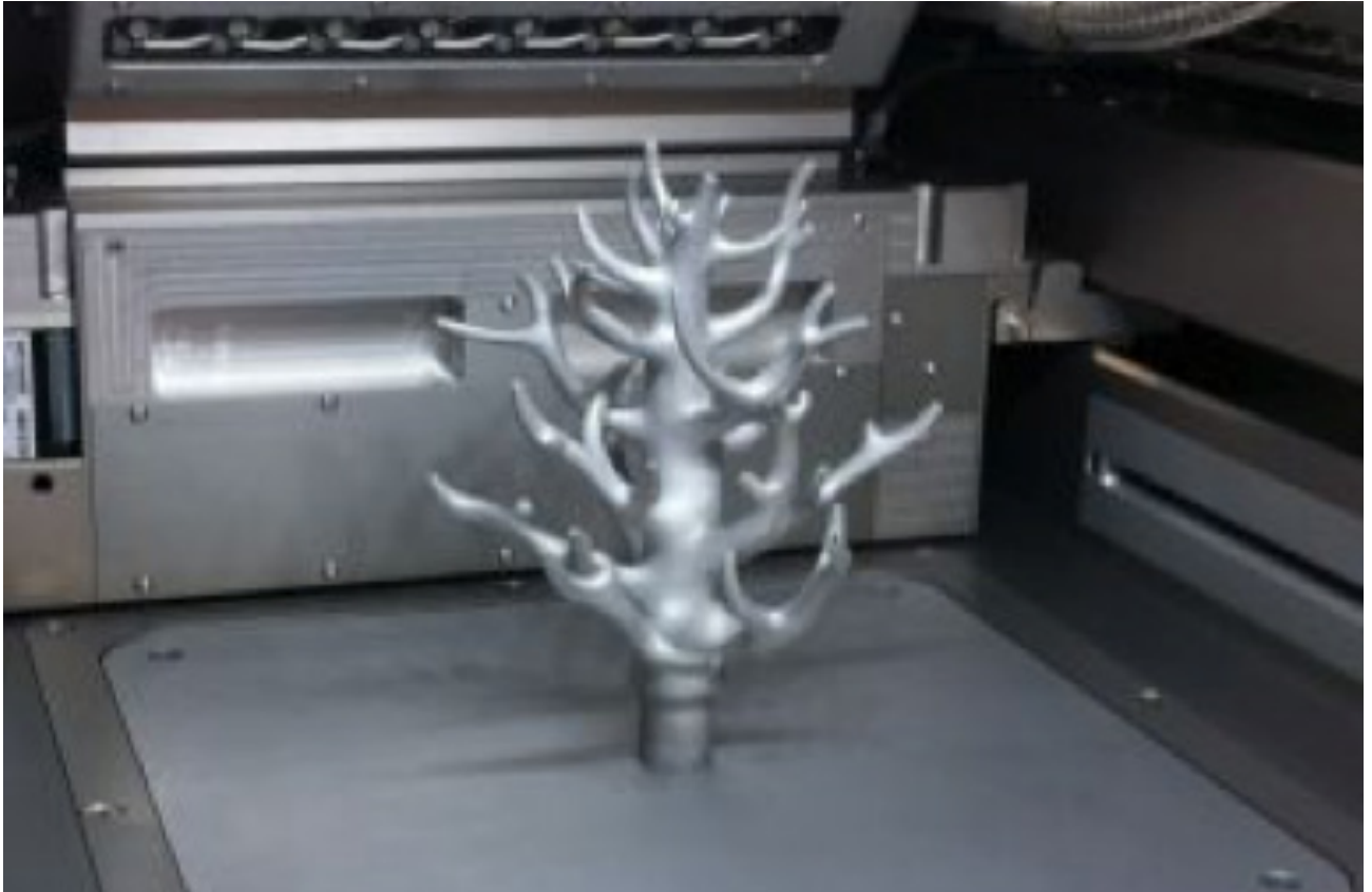
Fabricación aditiva por tecnología de fusión selectiva por láser (SLM/powderbedadditivemanufacturing). Pieza compleja acabada en la cámara de fabricación. (IK4-LORTEK)
