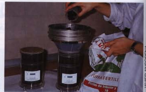
Sustratoen aire porositatea neurtzeko zilidroak, ingeles.
