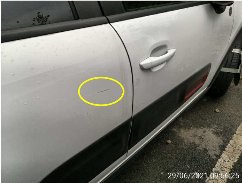
FOTO 04 Vista puerta lateral trasera, unas pequeñas rayas rozadas
