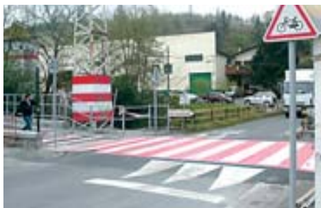
• Paso de vía ciclista sobre "lomo" de control de velocidad (Oiartzun).
