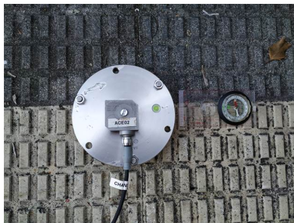
Figura 4. Detalle de colocación del acelerómetro.
