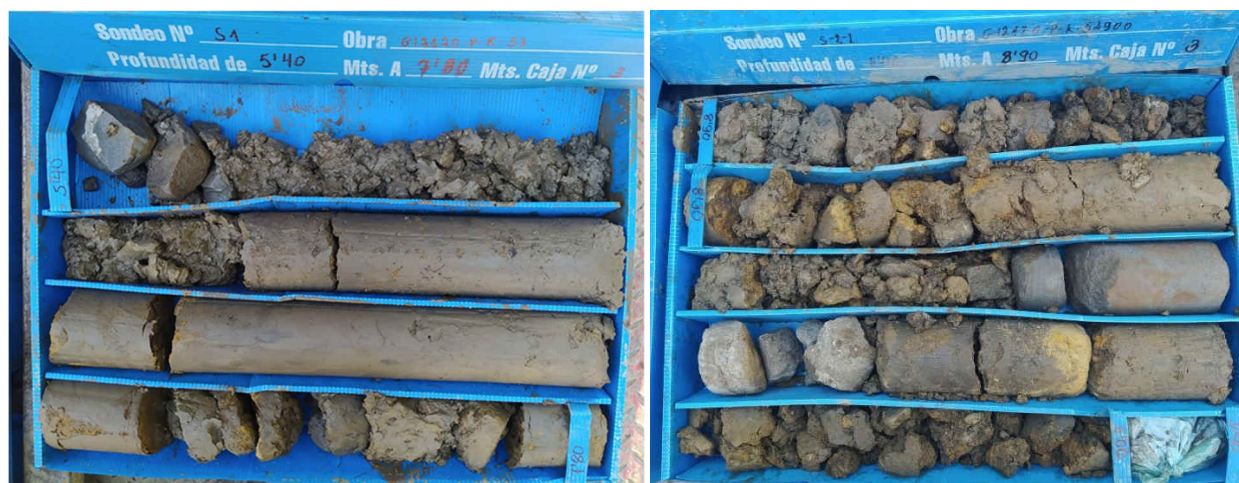
Figura 23. Suelos coluvio-eluviales del S-1 (imagen izquierda 5,4 - 7,8m) y del S-2 (imagen derecha 5,4 - 8,9m)
