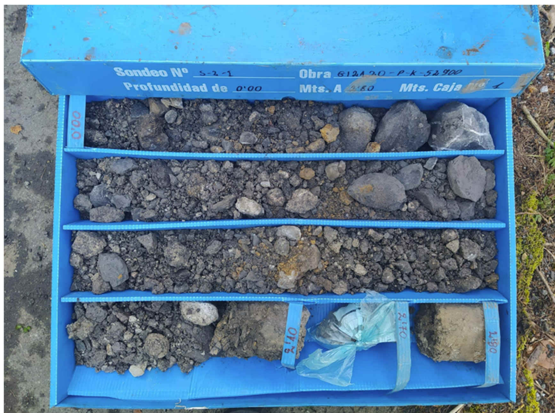
Figura 17. Aspecto de los rellenos antrópicos en el sondeo realizado para el presente informe (caja 1 del S-2).
