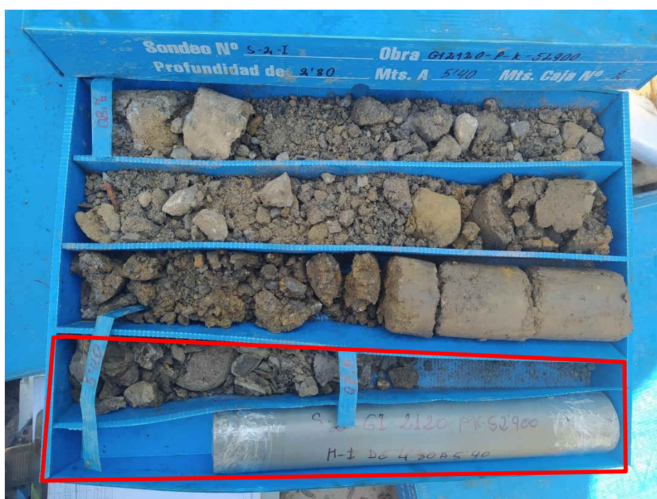
Figura 16. Aspecto del coluvial entre los 4,8 y 5,4 m de profundidad (Caja 2 del S-2).
