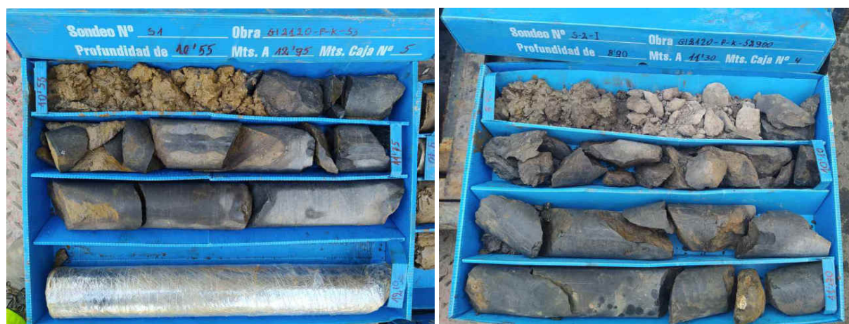
Figura 29. Izquierda Investigación S-1, roca de 10,9m a ,14,1m [R]. Derecha S-2 roca de roca de 9,4m a ,15,1m [R]
