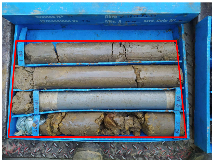
Figura 15. Aspecto del coluvial entre los 7,80 y 10,55 m de profundidad (Caja 4 del S-1).
