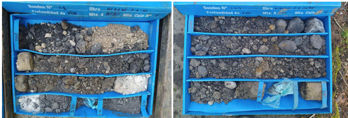
Figura 22. Rellenos en S-1, (imagen izquierda 0,0-2,3m) / y en S-2 (imagen derecha 0,0-2,80 m).
