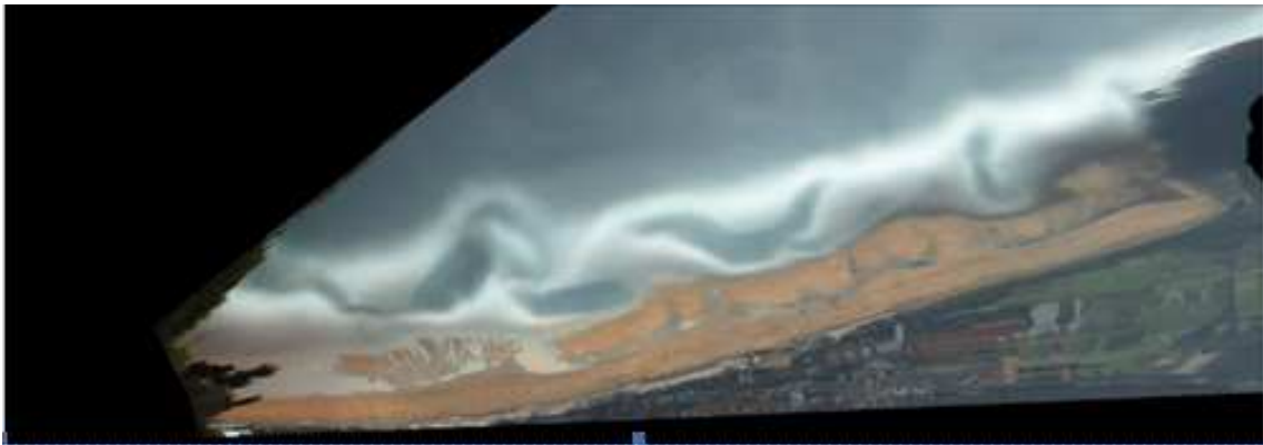
Figura 2. Ejemplo de aplicación de técnicas de monitorización costera mediante vídeo cámaras para el seguimiento de corrientes en la playa de Zarautz.
