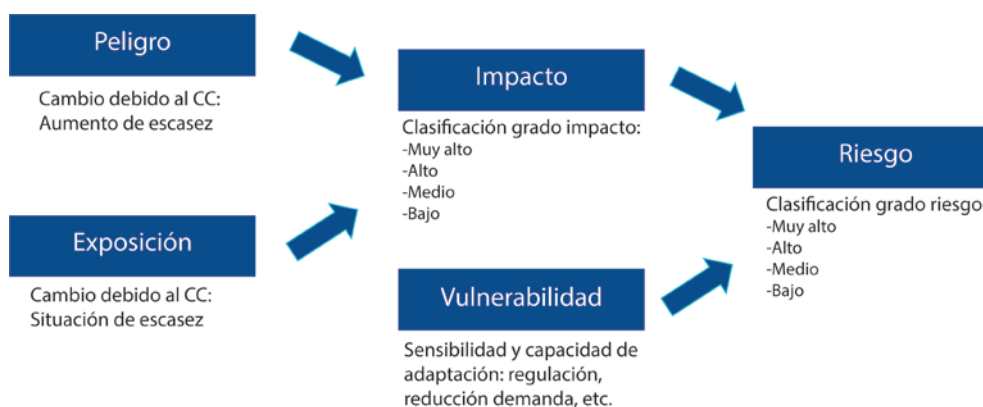
7.5. Fig. Esquema de la metodología propuesta para la determinación del riesgo asociado al cambio climático. Figura adaptada de Segrelles & Pérez-Martín (2021).
