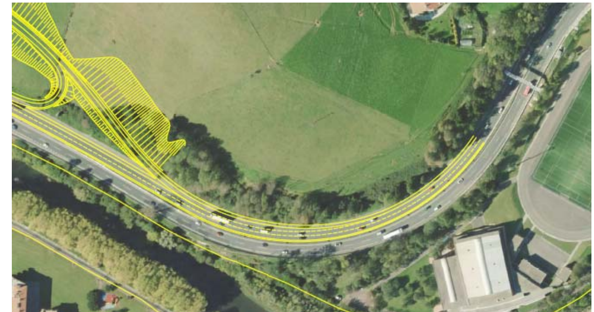
Variante VI, curva existente de R=178 m en eje N-I Tolosa
